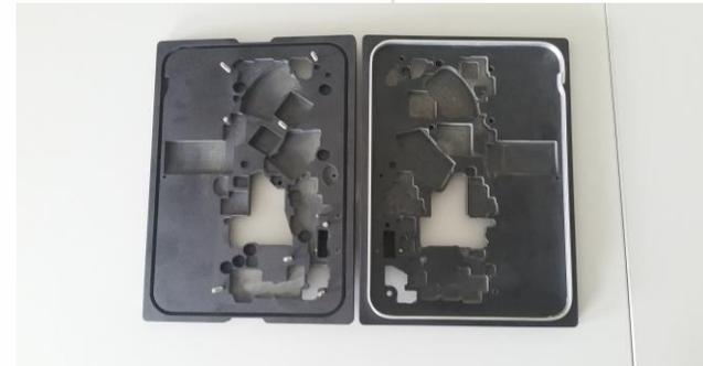
Cadre de vernissage avec capot et joint Aluminium
