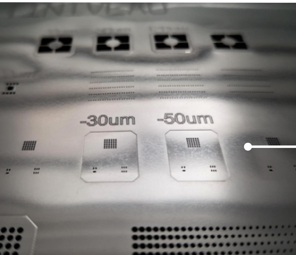
Positionnement des zones de surépaisseurs inférieures à 10µm
